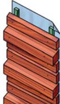
Horizontale open gevelbekleding
